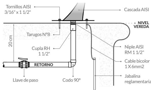
**PRECAUCIÓN:** Para una correcta y segura instalación es muy importante conectar a tierra, desde uno de los tornillos hacia una jabalina de descarga.
