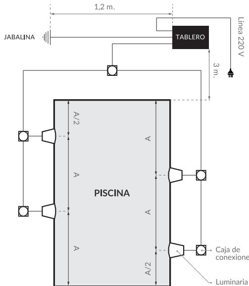
**ATENCIÓN:** Para la instalación de luminarias LED utilice cajas de conexión Vulcano, e incorpore prensacable para lámparas led COD. 247067.
