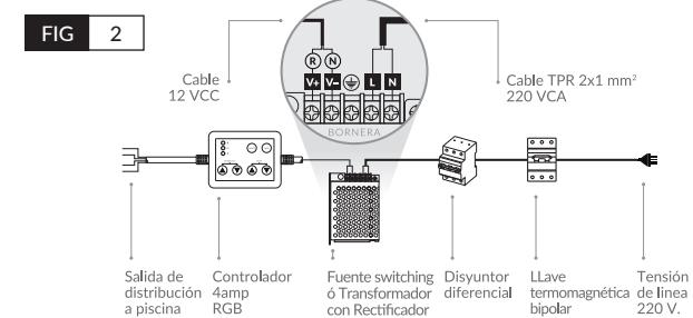
**IMPORTANTE:** Para mayor seguridad, instale a un disyuntor diferencial bipolar con potencia acorde al consumo, y con corriente diferencial no superior a 30 mA según IEC 335-2-4.
